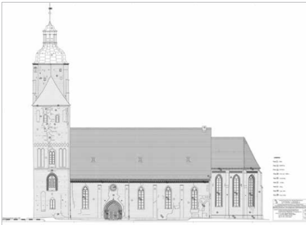
Elewacja południowa (rozwarstwienie murów naniesione na projekt rewaloryzacji), oprac. M. Małachowicz, R. Karnicki
